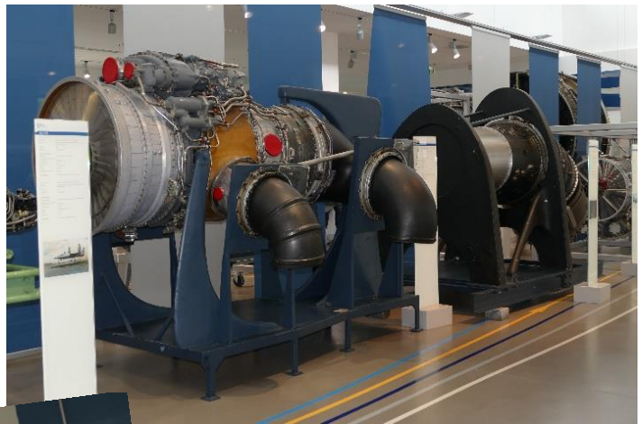
Antrieb für Senkrechtstarter (RB193-12) aus den 60er bis 70er Jahren
